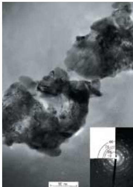
Et transmissionselektronmikroskopbillede af nano-diamanter fra Allende-meteoritten, hver klump indeholder ca. 1.000 diamanter, og hver diamant består af ca. 1.200 kulstofatomer. Hver klump af nanodiamanter er ca. 0.0001 mm i diameter. (Foto: ??????????)
